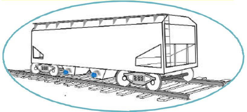
Los vibradores para vagones trabajan con un soporte tipo cuña que se deslizan dentro del compartimiento del vagón.
